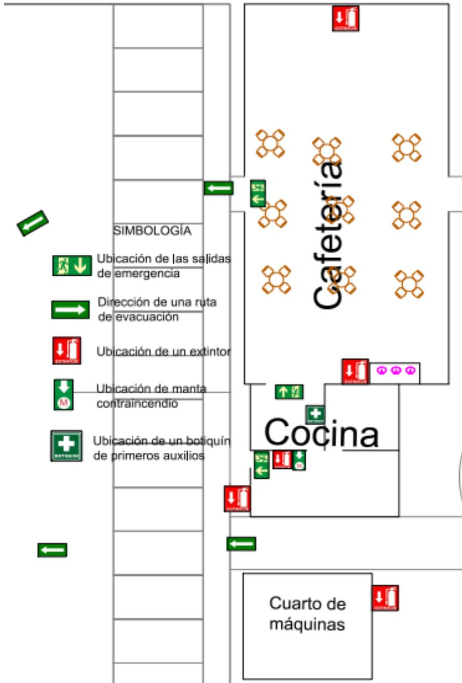
**Ilustración 4 Croquis 2. Rutas de evacuación, ubicación de extintores y botiquines de primeros auxilios y salidas de emergencia en Edificio de Docencia planta alta.**
