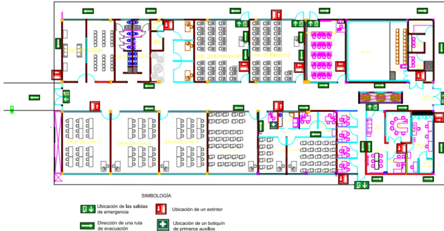
**Ilustración 11 Croquis 9. Rutas de evacuación, ubicación de extintores, botiquines de primeros auxilios y salidas de emergencia en Edificio de Laboratorios Laboratorio de gastronomía**
